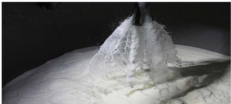
Bild 1: Calciumcarbonat-Pellets beim Austrag aus den Reaktoren
